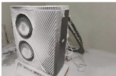
-25°C-on végzett extrém fagy teszt
